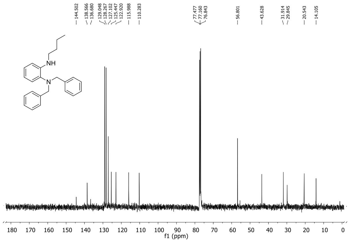
Figure 4.109. <sup>13</sup>C NMR of *N*<sup>1</sup>,*N*<sup>1</sup>-dibenzyl-*N*<sup>2</sup>-butylbenzene-1,2-diamine (**3**)
